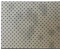
Manchas producidas por la humedad que ha filtrado en el interior del cuero.
