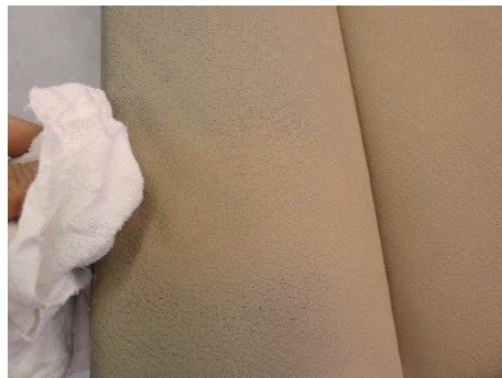
Desteñido de vaqueros en la entrada de un asiento de coche y desteñido de cinturón en el respaldo de un asiento de coche
