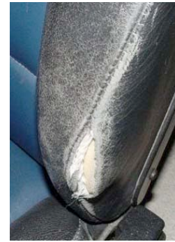
Demasiado cerca de la costura y demasiada tensión. Nuestra recomendación cambiar la pieza.
