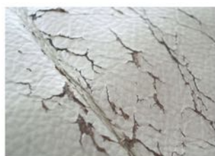
Cuero liso roto y agrietado
